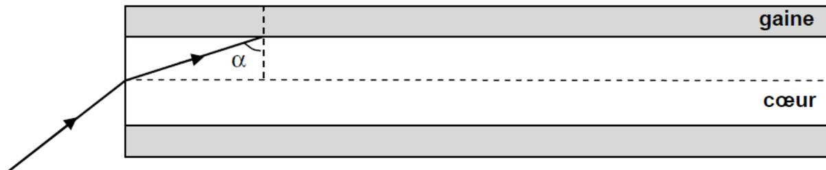
Pour une fibre en Plexiglas<sup>®</sup>, on donne l'indice de réfraction du cœur  $n_c = 1,495$  et celui de la gaine  $n_g = 1,485$ .
