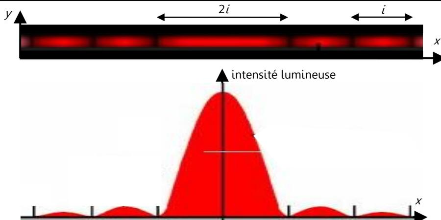
*Photographie de la figure de diffraction donnée par un laser rencontrant une fente verticale et répartition de l'intensité lumineuse tout au long de cette figure de diffraction ( $i$  est l'interfrange).*
