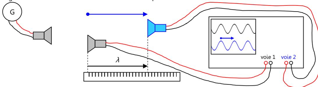
12. Pour réaliser cette mesure avec précision, comme la longueur d'onde  $\lambda$  n'est que de 1 cm environ, on déplace le 2<sup>nd</sup> récepteur non pas d'une seule longueur d'onde mais d'une dizaine de longueurs d'onde de façon à ce que la distance mesurée soit plus grande.
